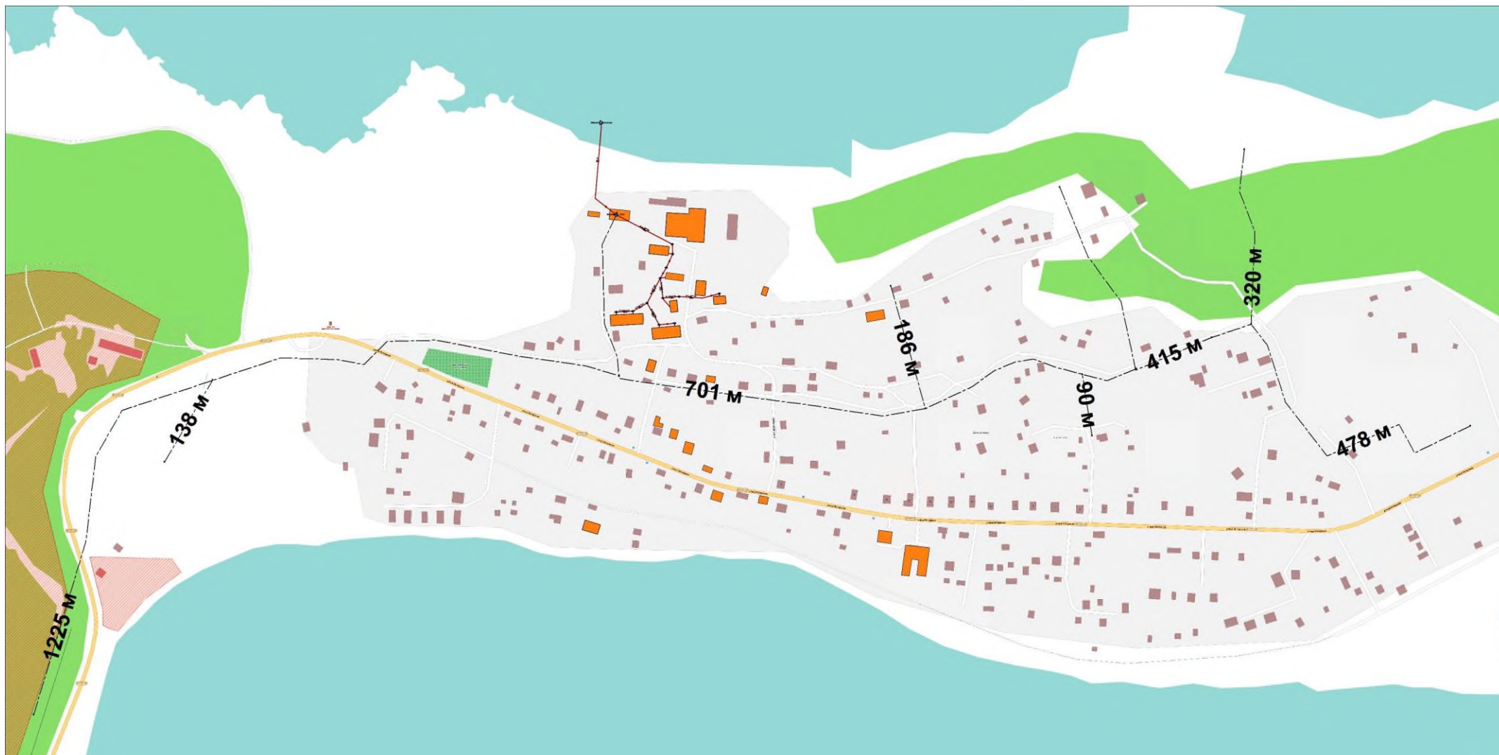
Рисунок 10 Схема водоотведения в д. Шепелёво (штрихпунктирная чёрная линия – ввод сетей с 2015 по 2030 гг.)
